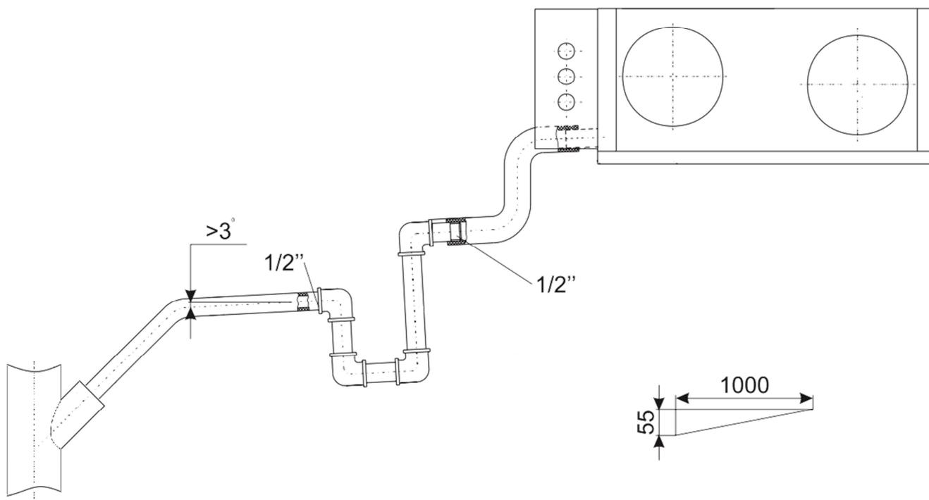
Уклон труб должен быть не менее  $3^\circ$  (1 м трубы должен быть наклонен вниз на 55 мм).
