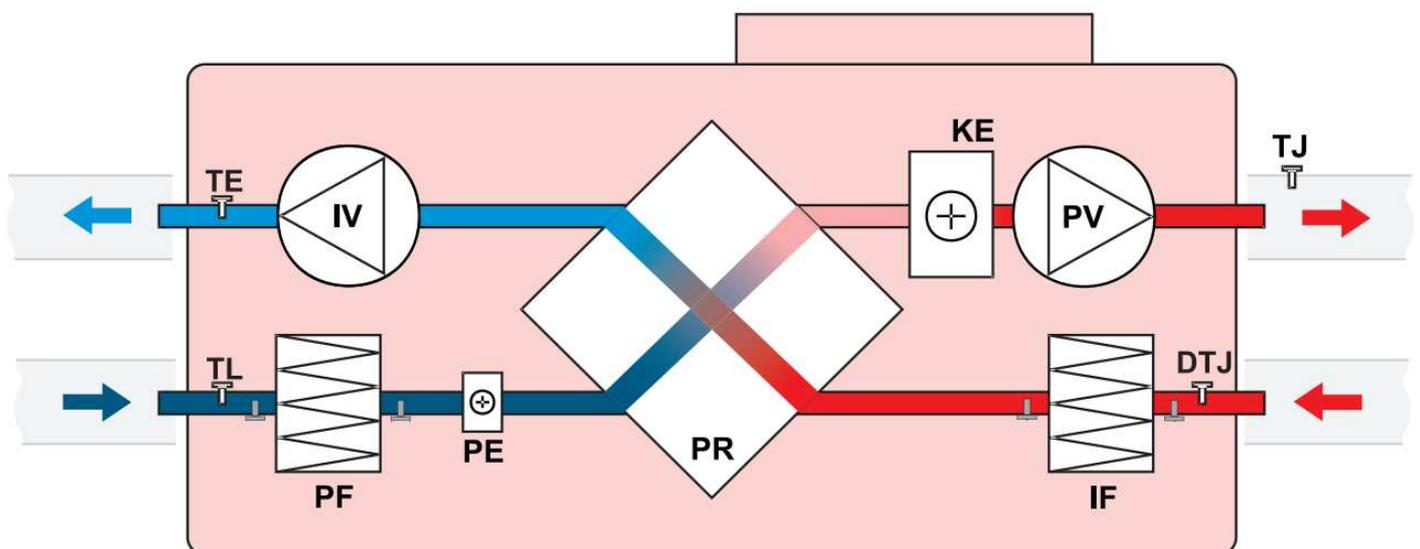
PV – вентилятор приточного воздуха;
