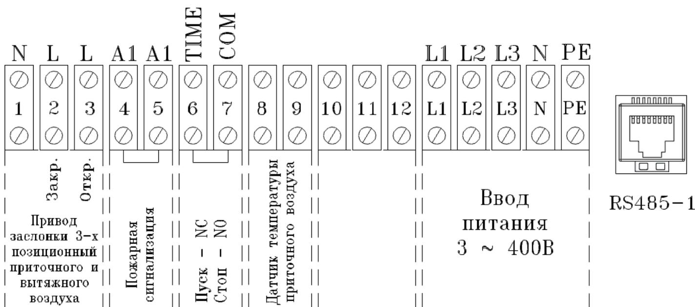
Подключить пульт управления соединительным кабелем в соответствующее гнездо блока управления (RS 485-1). Кабель входящий в состав комплекта к пульту не экранирован.
