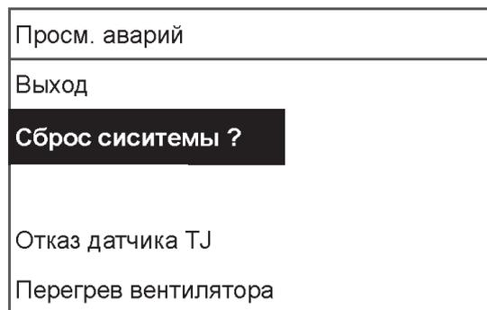
**Датчик TJ** – датчик температуры приточного воздуха (-40...+120 °С).
